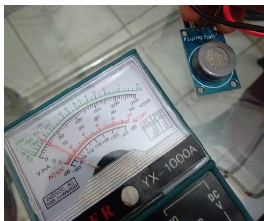
Gambar 4.6 Pengukuran Tegangan MQ-7 Sumber: Penulis, 2021
