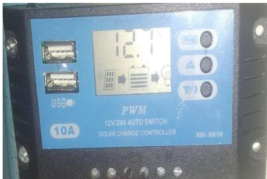
Gambar 4. 1 Monitor Sistem Panel Surya pada Modul SCC
