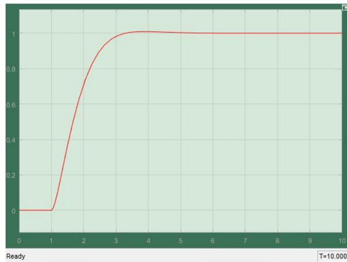
Gambar 4.14 Hasil Kendali Proportional dan Integrative pada Matlab Simulasi
