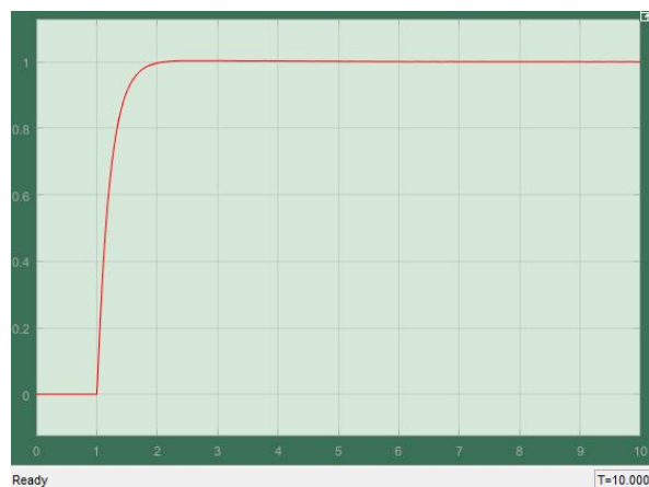
Gambar 4.16 Hasil Kendali Proportional + Integrative + Derivative pada Matlab Simulasi
