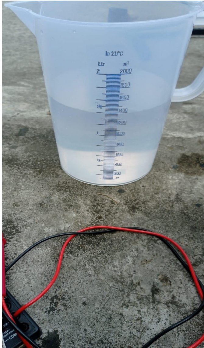
Gambar 4.5 pengukuran debit air awal yang dibutuhkan pada saat penyiraman panel solar sell berlangsung sampai ke suhu normal.
