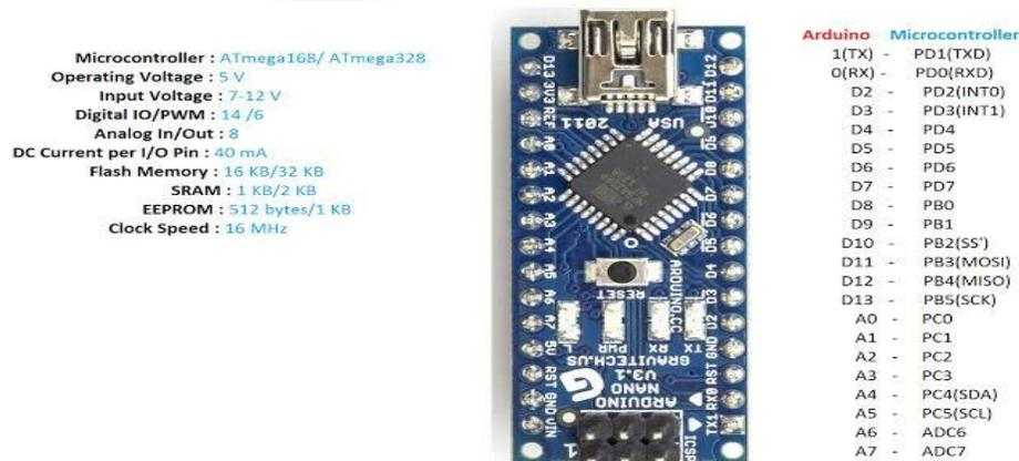
**Gambar 2.4 Susunan pin (kaki) Arduino Nano**
