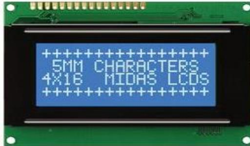
**Gambar 2.9 Bentuk Fisik LCD**
