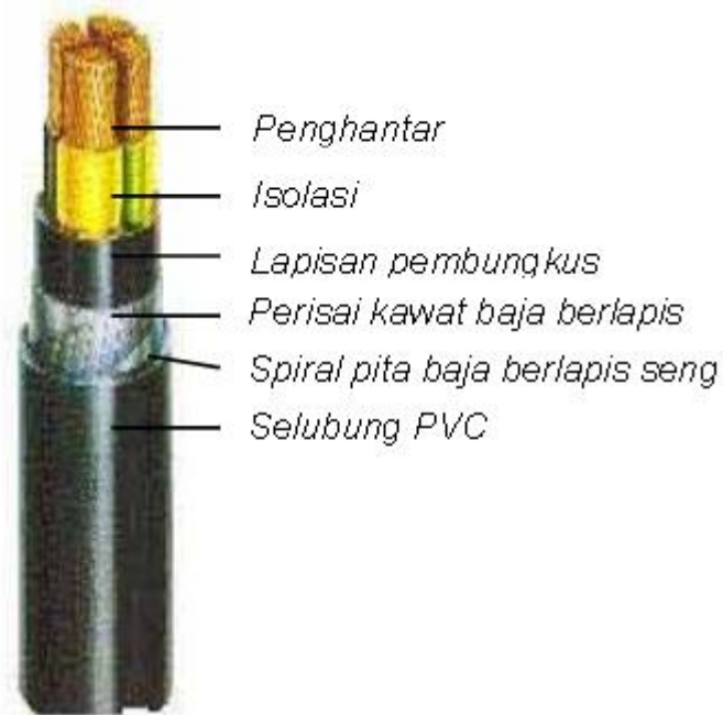
Gambar 2.5: Penghantar NYFGbY Sumber: bysoncable, 2016
