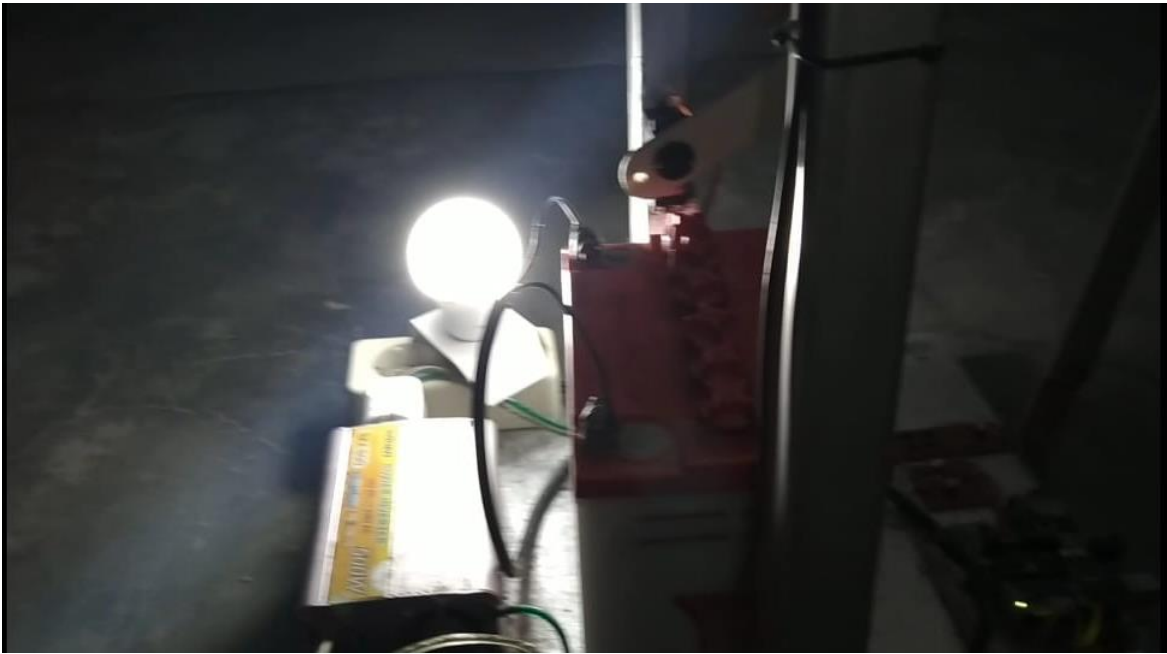
Gambar 4.3 Hasil Pengujian dengan Beban Lampu 18 Watt
