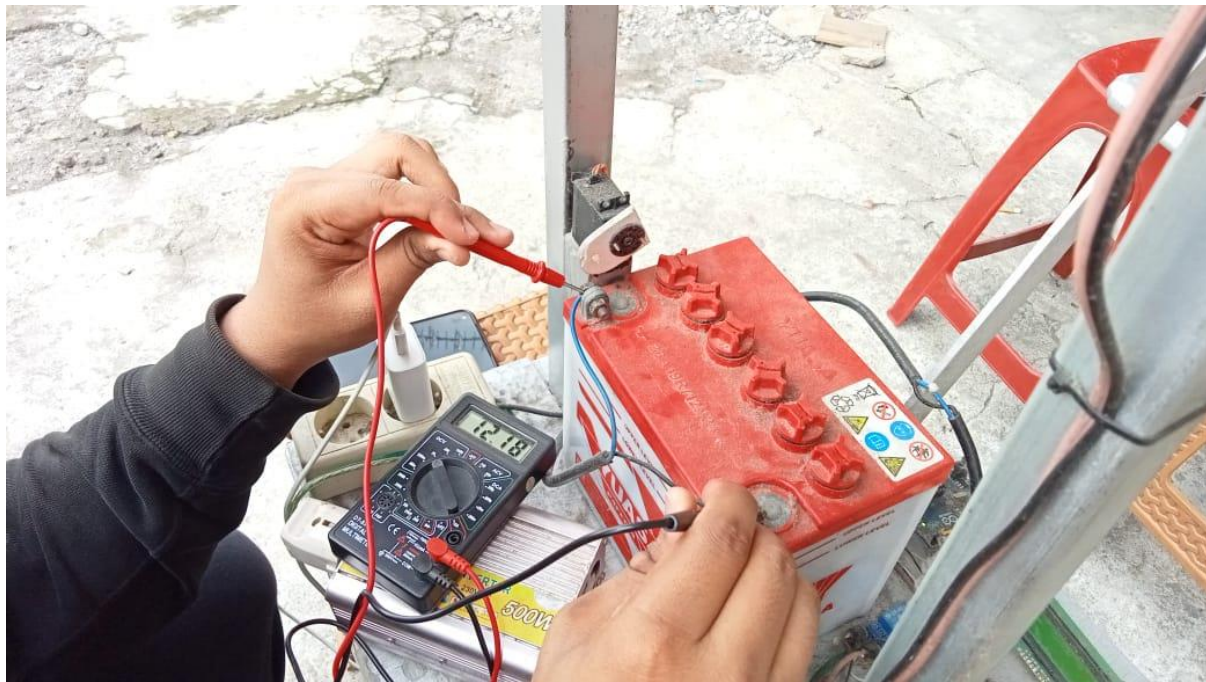
Gamabar 4.1 Hasil Pengukuran Tegangan (V) saat Pengisian Baterai
