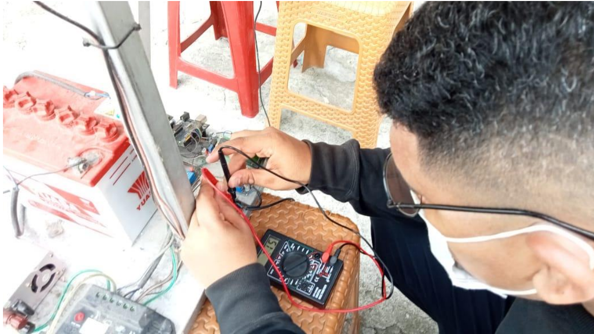
Gambar 4.1 Hasil Pengukuran Arus (I) saat Pengisian Baterai
