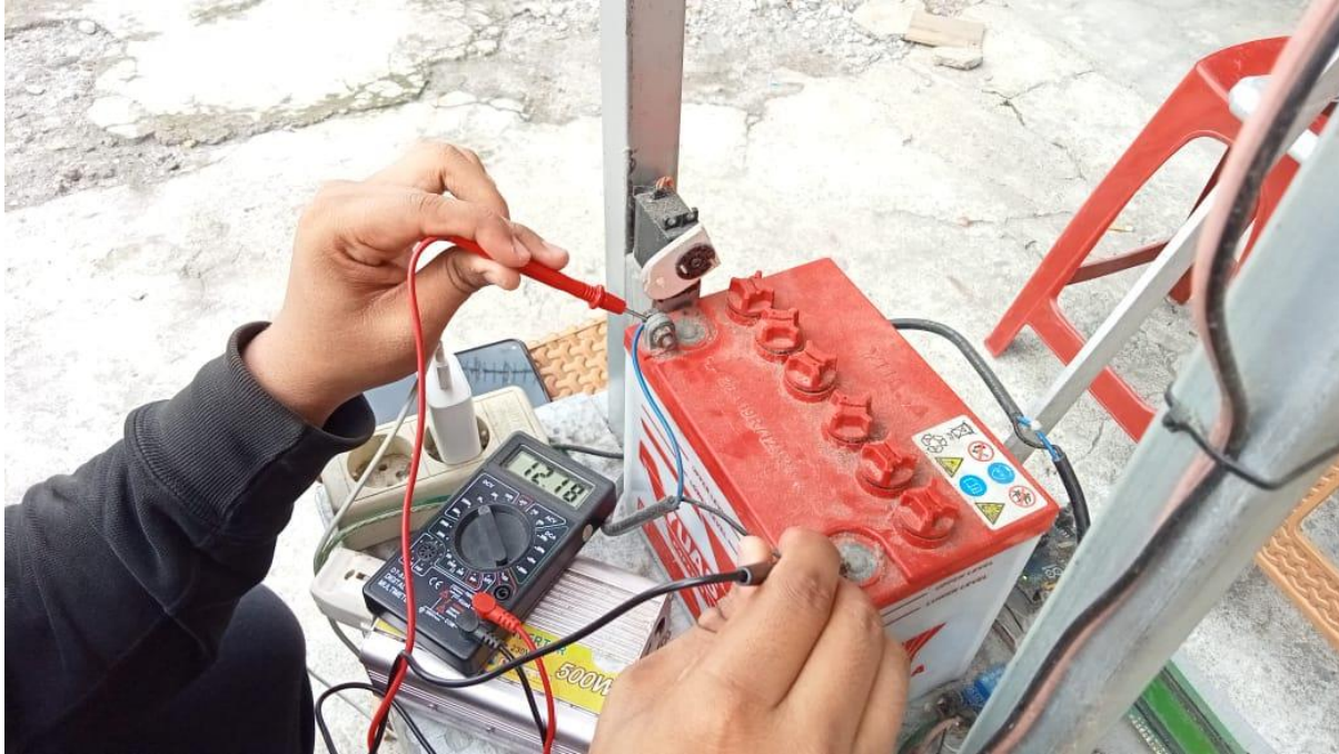
Gambar 4.4 Hasil Pengujian dengan Beban Charger Handphone 10 Watt
