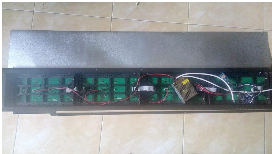
Gambar 4. 4 Konfigurasi Kabel Modul P10
