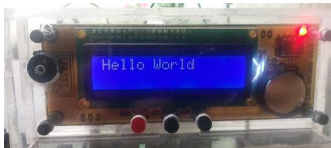
Gambar 4.8 Tampilan LCD dengan Tampilan “ Hello World ”
