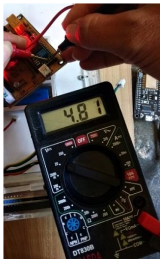
Gambar 4.7 Hasil Pengukuran Tegangan I2C LCD
