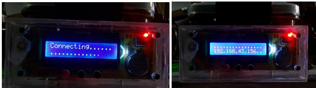
Gambar 4.16 Tampilan LCD Sewaktu Nodemcu Mencari Koneksi dan Terhubung
