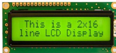
Gambar 2.15 Modul LCD 2 x 16 Karakter
