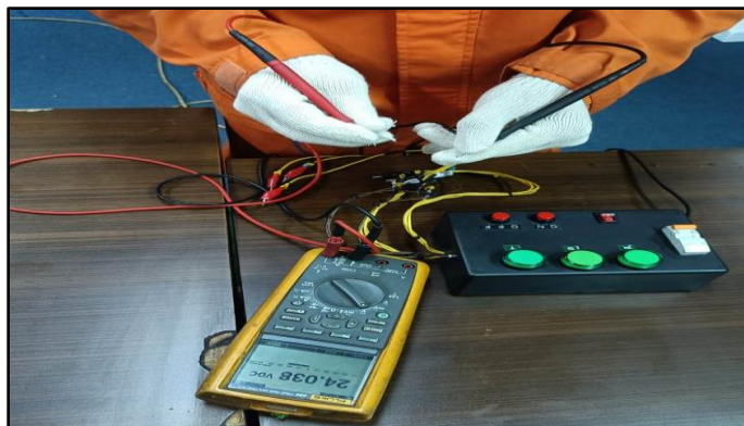
Gambar 4.3 Pengujian Tegangan Output DC
