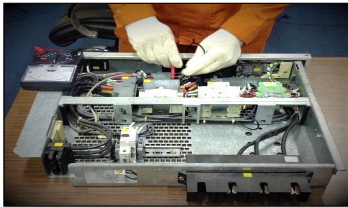
Gambar 3.1 Pengukuran Dengan Multitester Yang Kurang Efektif
