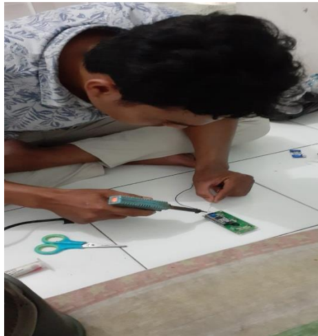
Gambar 3.3 Penyolderan Kabel LCD Sumber : Penulis, 2021
