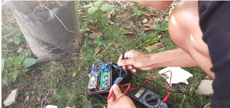
Gambar 4.3 Pengukuran Tegangan Di Relay
