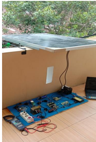
Gambar 4.1. Rangkaian perangkat solar charge controller
