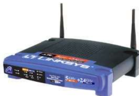
Gambar 2.6 Wireless Router atau Access Point Sumber: Moh. Tezar dan Agung Walenta, 2016
