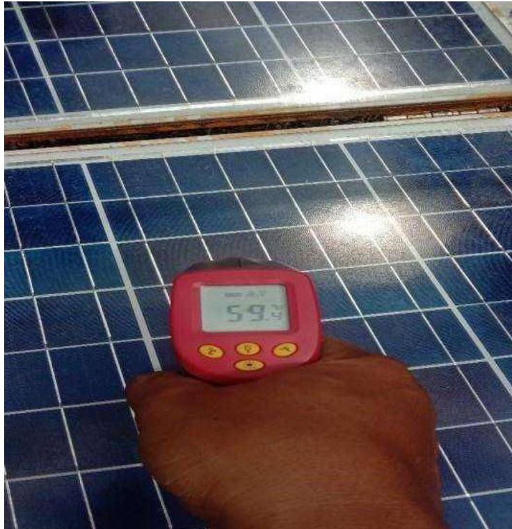
Gambar 4. 8 Temperatur Panel Surya dengan Penambahan Cermin Reflektor pada Jam 12.00
