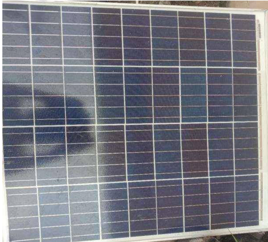
Gambar 3.2 Panel Surya polycrystalline Sumber : penulis, 2020
