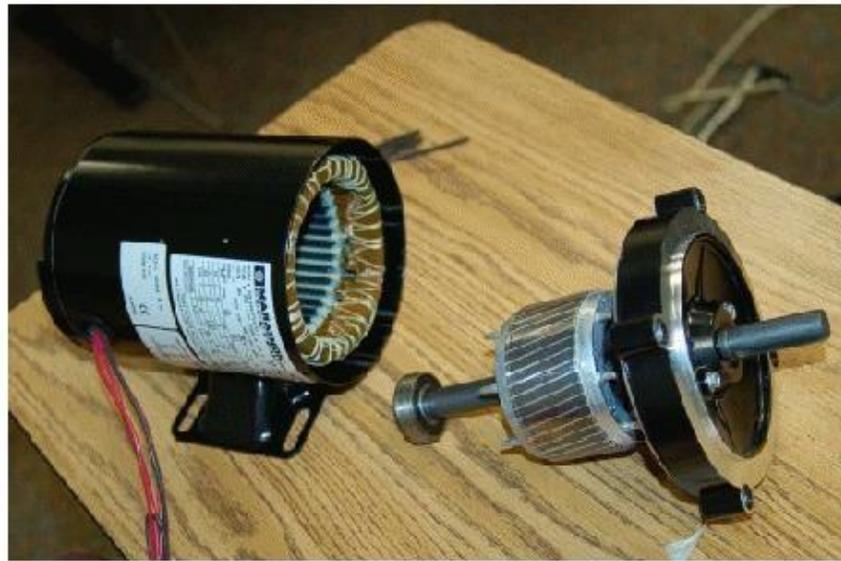
**Gambar 2.3 Motor Induksi Rotor Sangkar**
