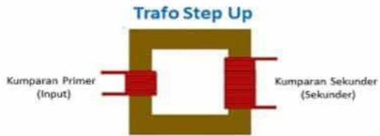
Gambar 2. 2 Skema Trafo Step Up Sumber: Azzahra, 2021
