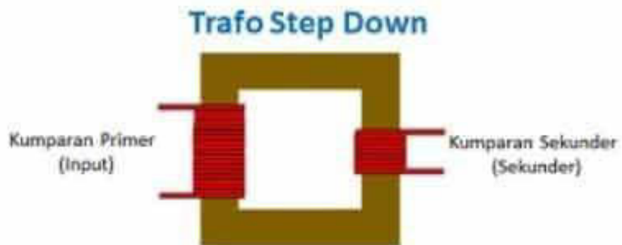
Gambar 2. 3 Skema Trafo Step Down Sumber: Azzahra, 2021
