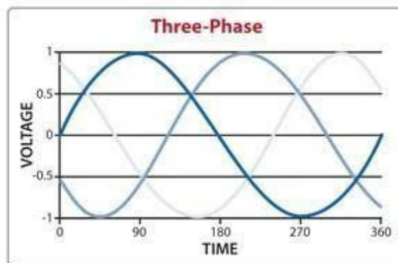
**Gambar 2.11 Bentuk Gelombang sistem 3 fasa normal dengan urutan RST**
