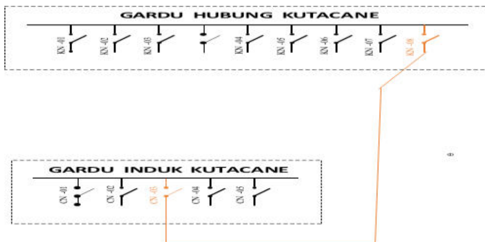
Gambar 3.6.1 Diagram Alir Gardu Induk Ke Gardu Hubung
