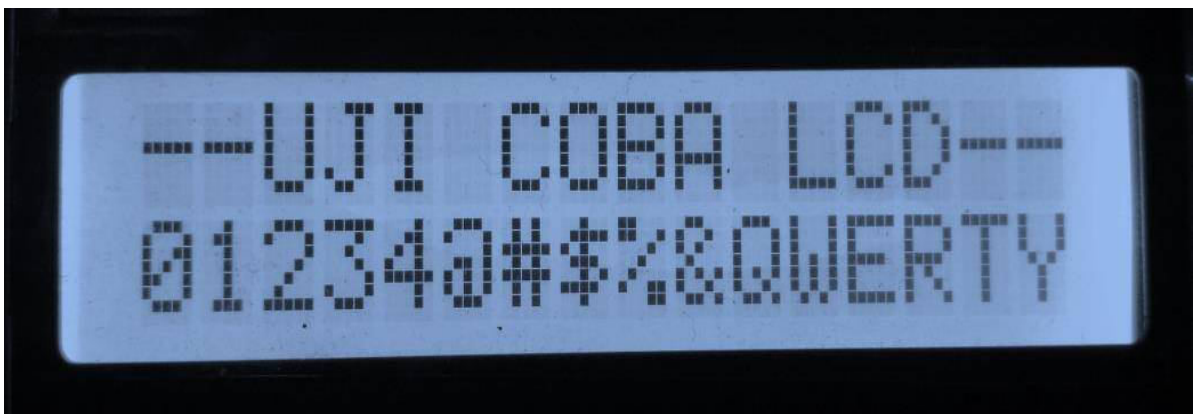
Gambar 4.9. Foto Hasil Pengujian LCD 16 x 2
