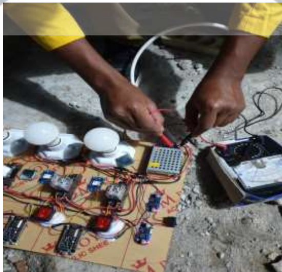
Gambar 4.1 Pengujian Keluaran Catu Daya
