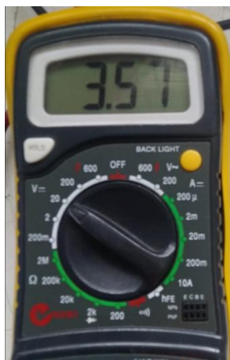
Gambar 4.9 Pengukuran TP 6 pada multimeter berbeban
