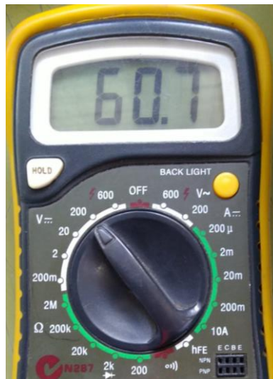
Gambar 4.32 Pengukuran TP3 pada multimeter tanpa beban
