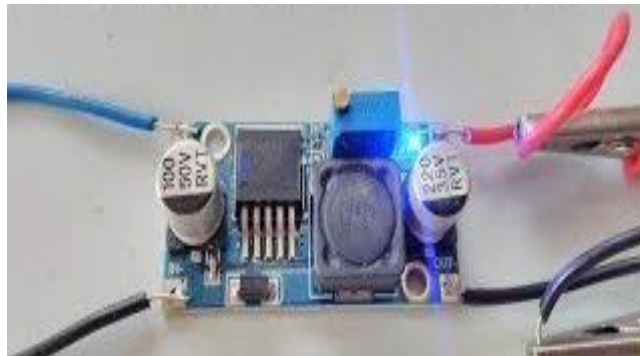
Gambar 2.22 Modul LM2596 Sumber: Dokumentasi Penulis, 2022
