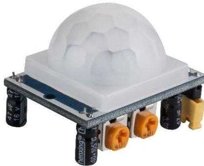
**Gambar 2.10 Bentuk fisik Sensor Gerak**
