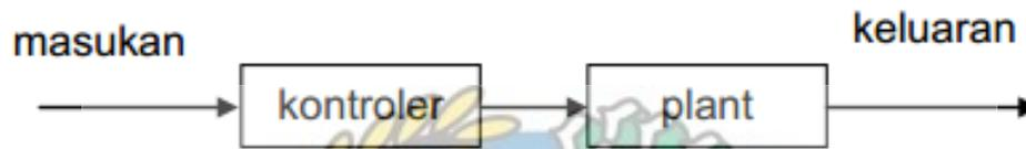
**Gambar 2.1 Sistem Kontrol Loop Terbuka**
