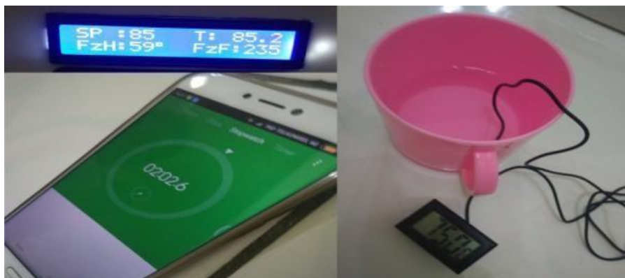
Gambar 4.12 Pengujian Suhu Dallas 85 °C dan Termometer 75.0 °C Sumber : Ahmad Ikhwari, 2020
