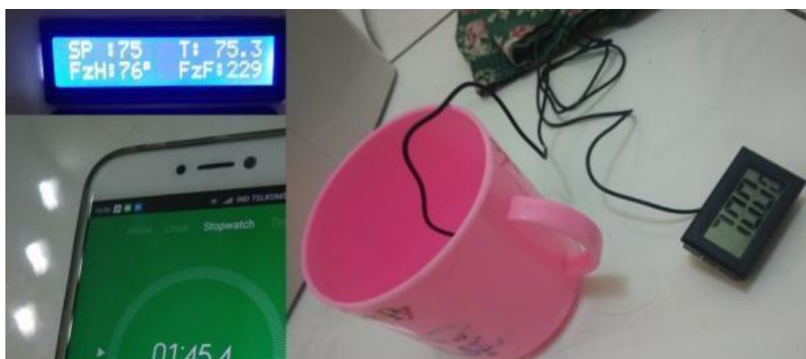
Gambar 4.10 Pengujian Suhu Dallas 75 °C dan Termometer 70.0 °C Sumber : Ahmad Ikhwari, 2020
