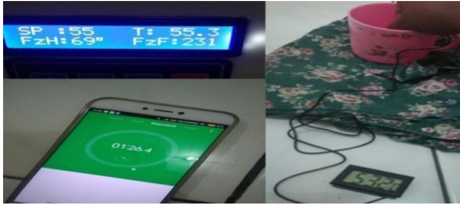
Gambar 4.6 Pengujian Suhu Dallas 55 °C dan Termometer 53.2 °C Sumber : Ahmad Ikhwari, 2020
