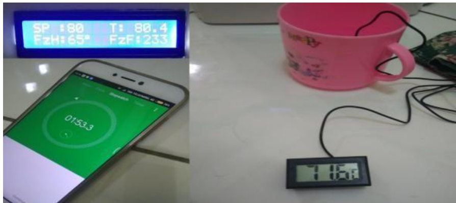
Gambar 4.11 Pengujian Suhu Dallas 80 °C dan Termometer 71.6 °C Sumber : Ahmad Ikhwari, 2020
