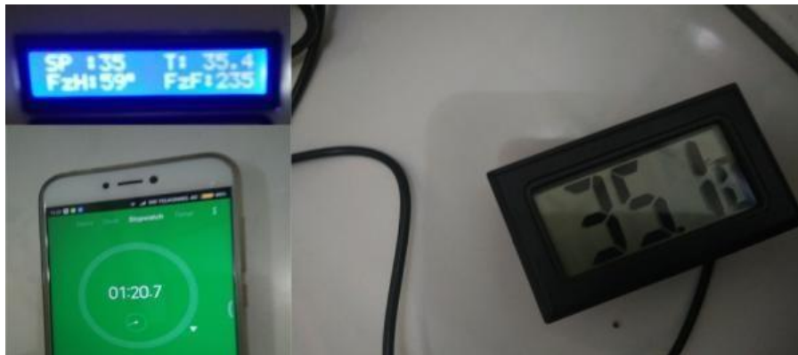
Gambar 4.2 Pengujian Suhu Dallas 35 °C dan Termometer 35.1 °C Sumber : Ahmad Ikhwari, 2020
