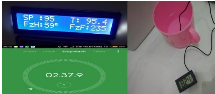
Gambar 4.14 Pengujian Suhu Dallas 95 °C dan Termometer 82.4 °C Sumber : Ahmad Ikhwari, 2020
