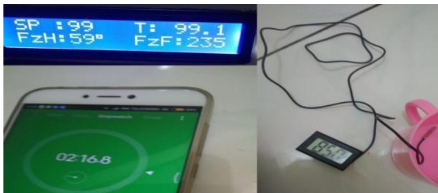
Gambar 4.15 Pengujian Suhu Dallas 99 °C dan Termometer 85.0 °C Sumber : Ahmad Ikhwari, 2020
