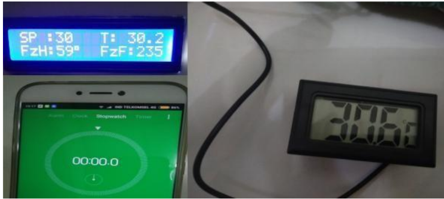
Gambar 4.1 Pengujian Suhu Dallas 30 °C dan Termometer 30.6 °C Sumber : Ahmad Ikhwari, 2020
