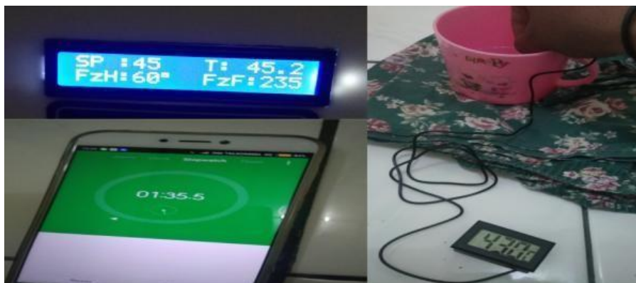
Gambar 4.4 Pengujian Suhu Dallas 45 °C dan Termometer 43.0 °C Sumber : Ahmad Ikhwari, 2020
