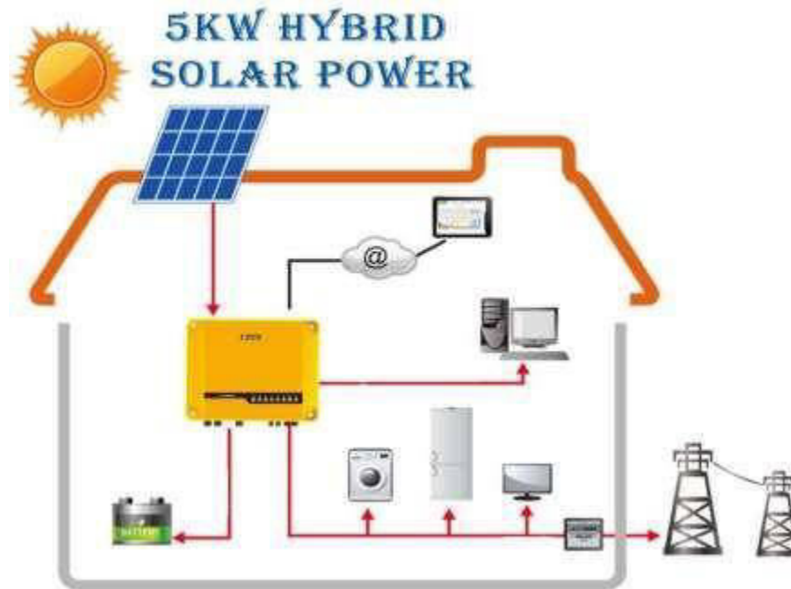
Gambar 2.3 Prinsip Kerja PLTS On-Grid
