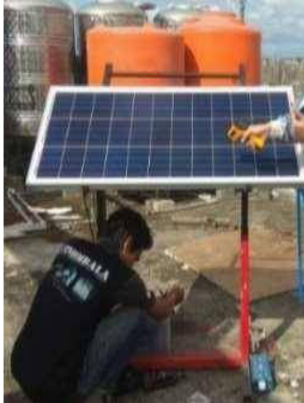
Gambar 4.1 Pengukuran Temperatur Panel Surya Tanpa Pendingin Penulis,2020
