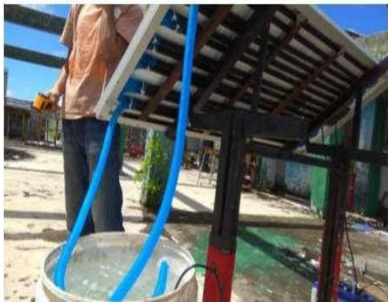
Gambar 4.2 Pengukuran Panel Surya Menggunakan Pendingin Sumber: Penulis,2020
