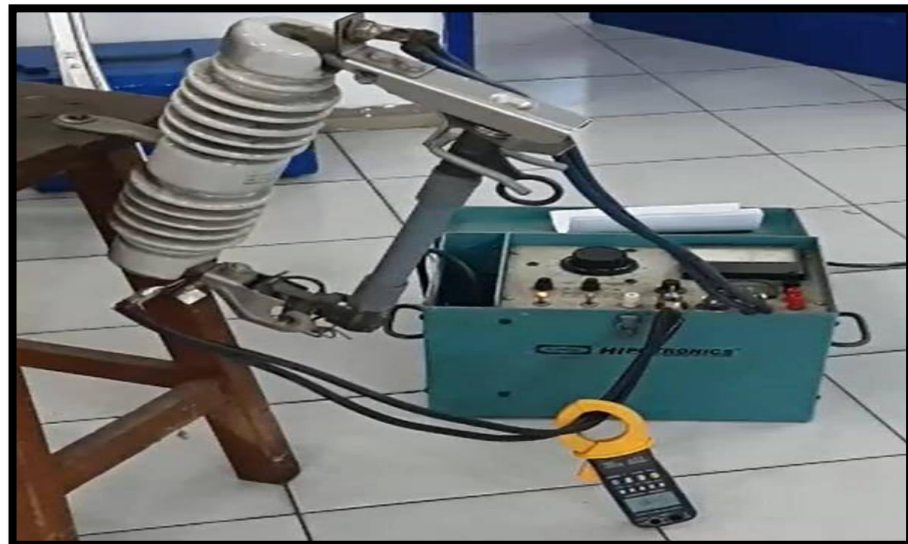
Gambar 3.13 Pengujian FCO Setelah Modifikasi Tabung FCO Sumber : PLN UP3 Medan, 2021
