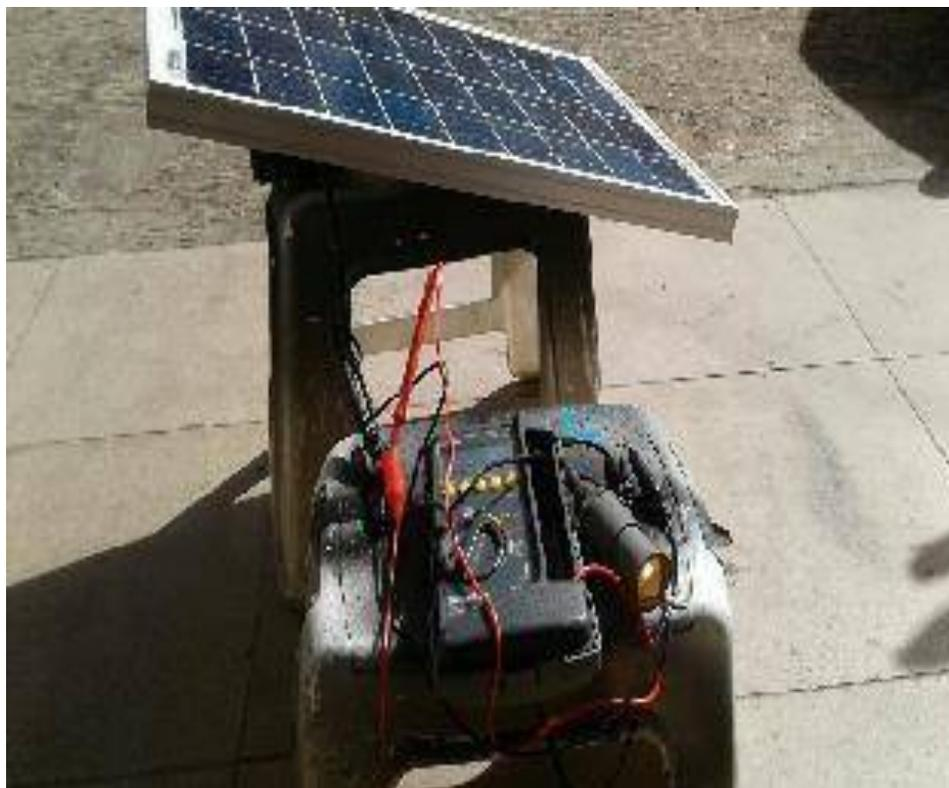
**Gambar 4.3 Pengukuran Panel Surya dengan Beban 20 Watt**
