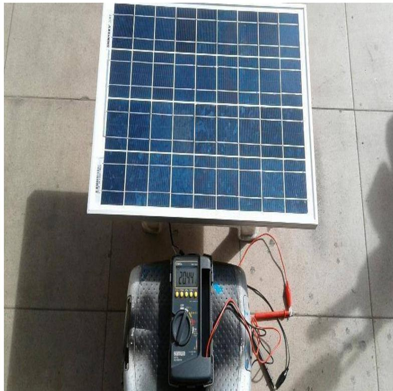
**Gambar 4.1 Hasil Pengukuran Panel Surya Tanpa Beban**
