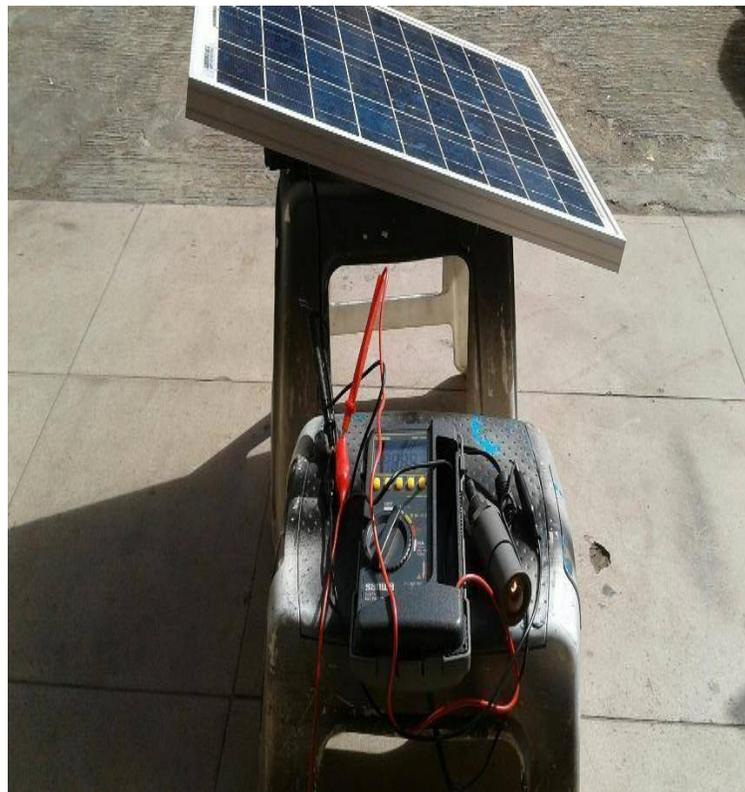
**Gambar 4.2 Pengukuran Panel Surya dengan Beban 10 Watt**
