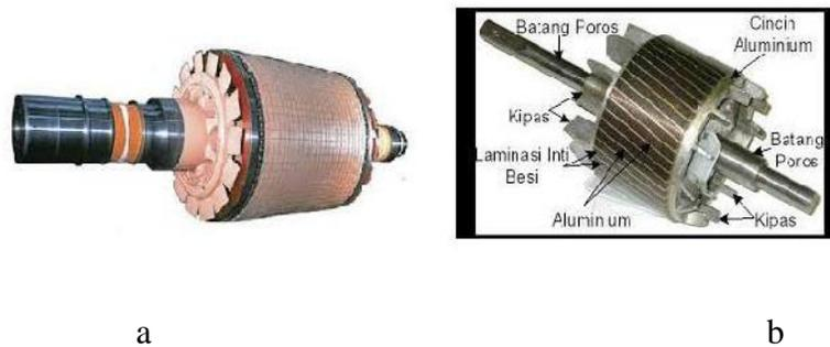
Gambar 2.5 struktur rotor motor induksi rotor sangkar
