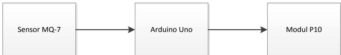
**Gambar 3.2 Blok Diagram**
