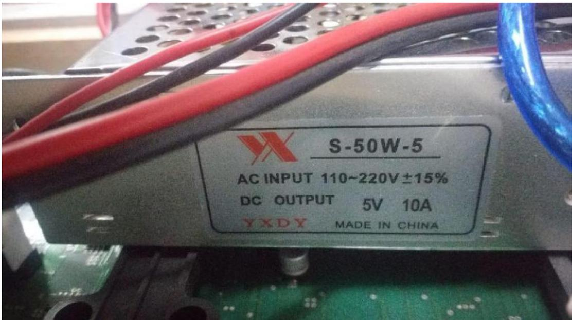
**Gambar 4.3 Spesifikasi Power Supply**
