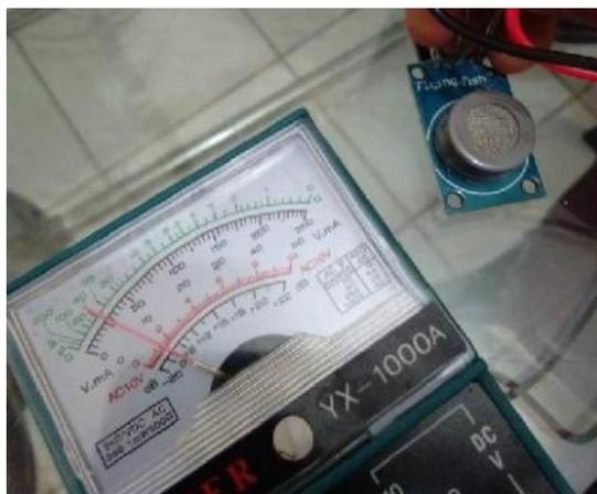
**Gambar 4.6 Pengukuran Tegangan MQ-7**
