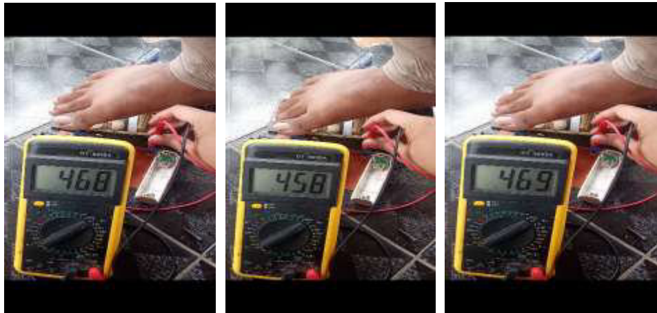
Gambar 4.6 Pengukuran I, II, III Beban 90 Kg Pada Prototype Rangkaian Paralel
