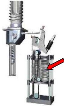
Gambar 2.12. Sistem Pegas Pilin (Helical)
