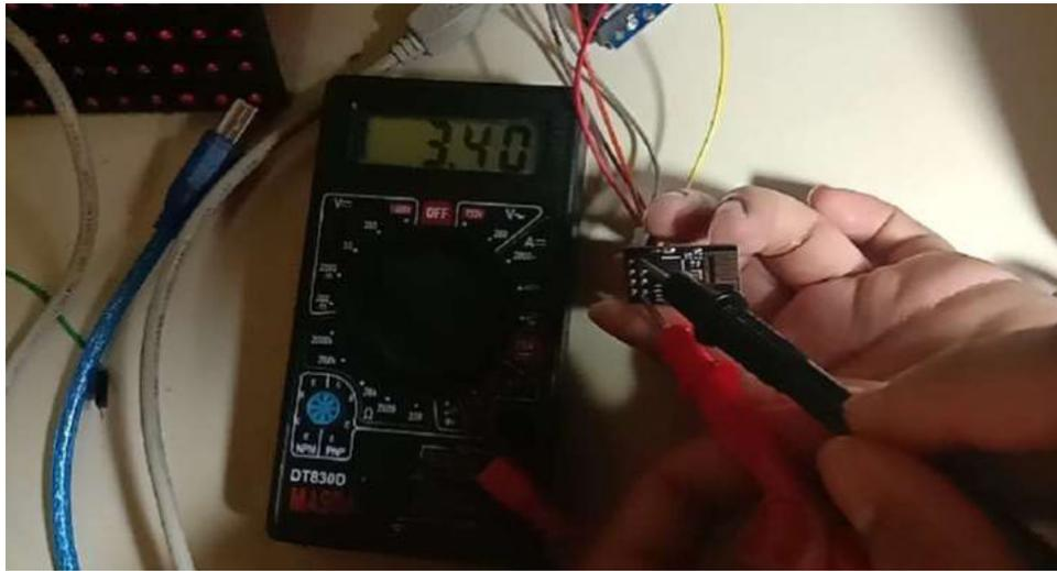
**Gambar 4.2(b) Pengukuran tegangan pin Ground-Rx pada esp8266**
