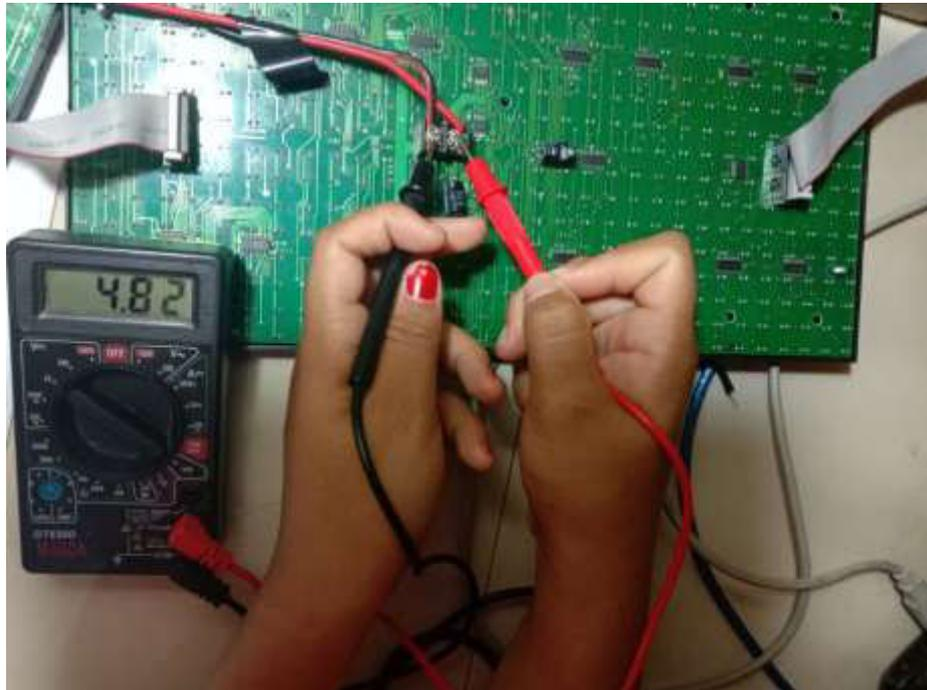
**Gambar 4.3 Pengukuran tegangan input modul p10**
