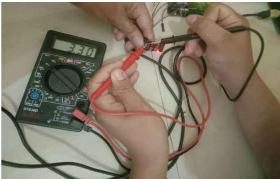
**Gambar 4.2(c) Pengukuran tegangan pin Ground-Tx pada esp8266**
