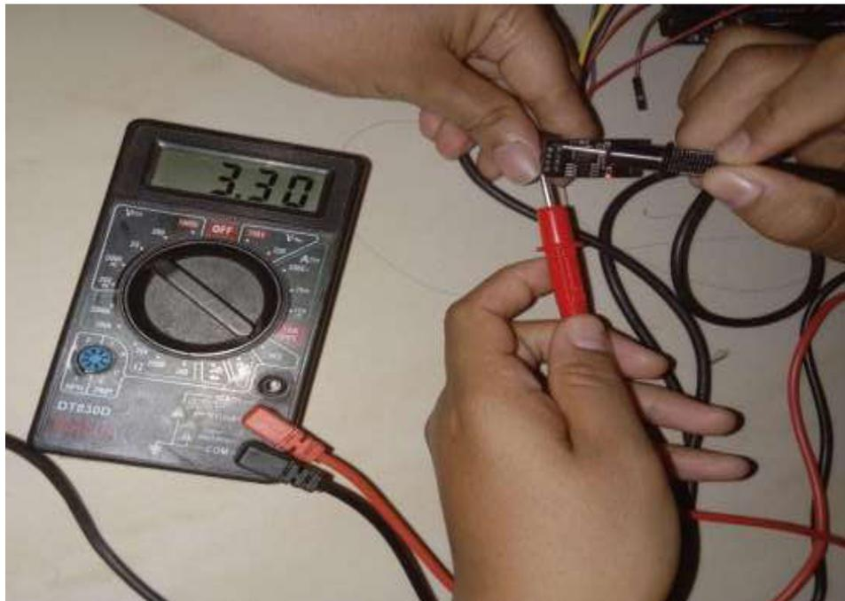
**Gambar 4.2 (a) Pengukuran tegangan pin Ground-Vcc pada esp8266**
