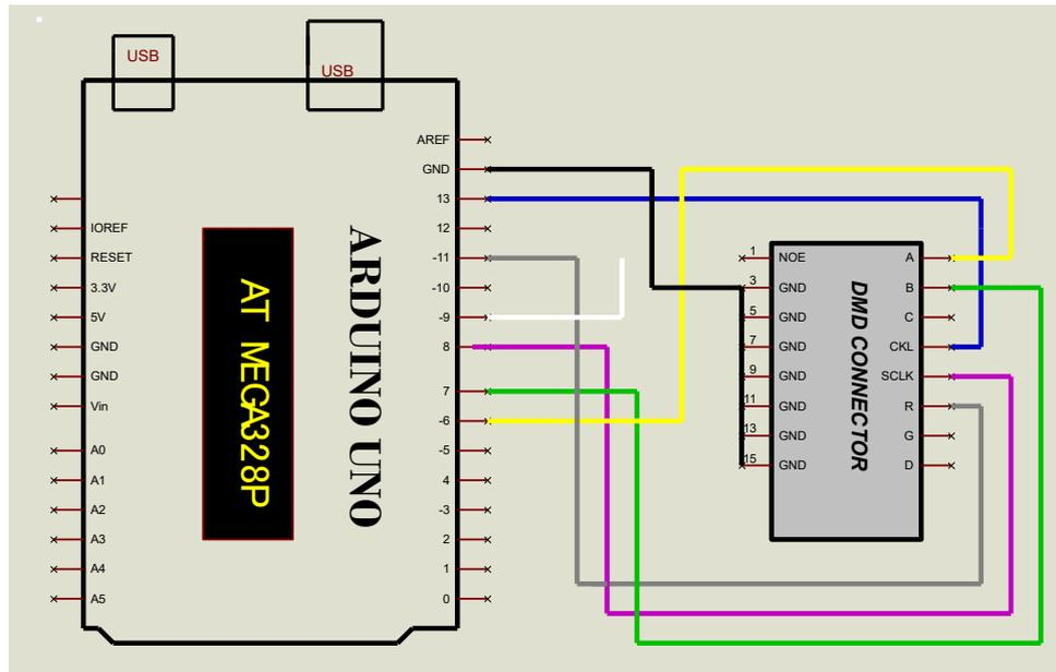
**Gambar 3.5 Rangkaian DMD konektor dengan Arduino Uno**
