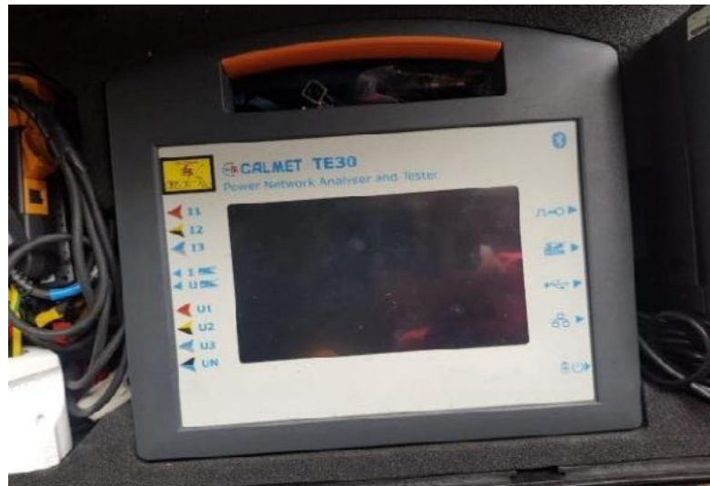
Gambar 3.11 Calmet TE30 Peralatan Alat Ukur Error KWH Sumber: Penulis
