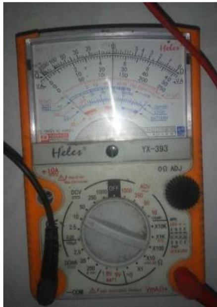
**Gambar 4.5.** Foto Pengujian Tegangan Power Supply
