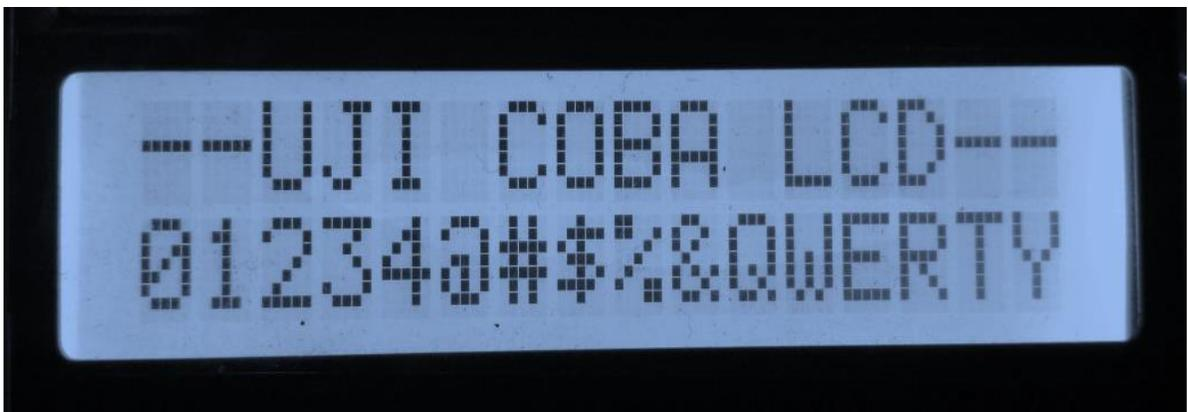
**Gambar 4.9.** Foto Hasil Pengujian LCD 16 x 2
