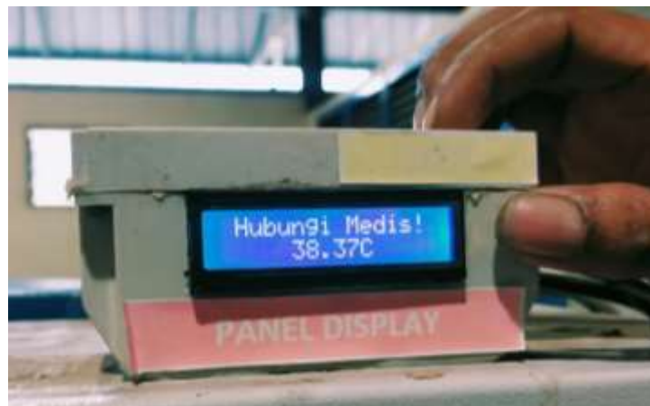
Gambar 4.3 Mengukur Suhu Tubuh Tidak Normal Sumber: Penulis,2021
