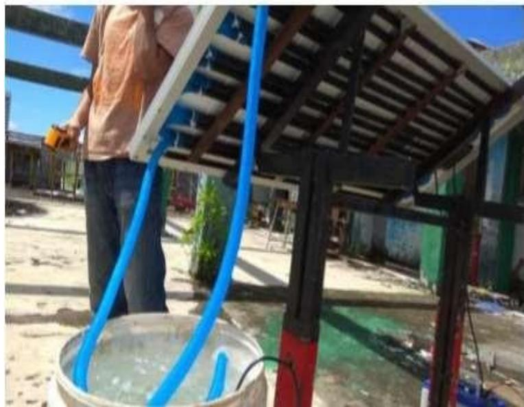
**Gambar 4.2 Pengukuran Panel Surya Menggunakan Pendingin**
