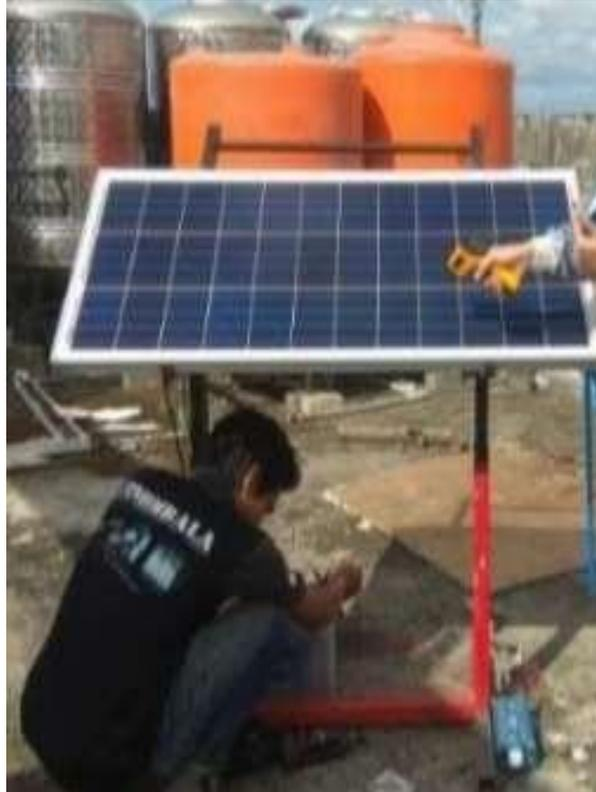
**Gambar 4.1 Pengukuran Temperatur Panel Surya Tanpa Pendingin**
