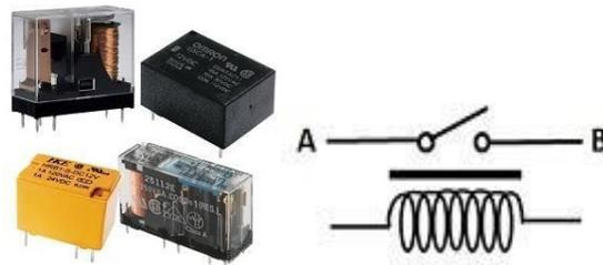
**Gambar 2. 6 Relay dan Simbol Relay**
