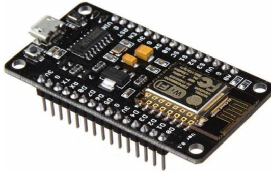
***Gambar 2. 1 ESP8266, Salah satu mikrokontroler populer untuk IOT***
