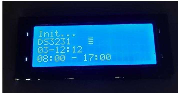
**Gambar 4. 3 Pengujian Modul RTC**
