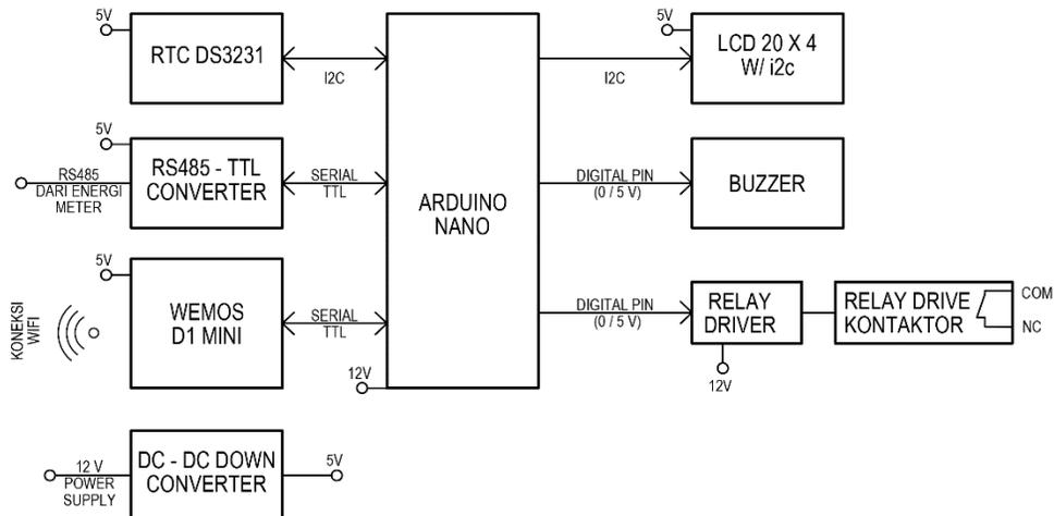
**Gambar 3. 1 Skema komunikasi data Arduino Nano**
