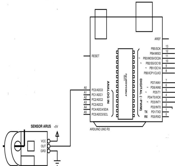
**Gambar 3.4 Rangkaian Sensor Arus Pada Arduino Uno**
