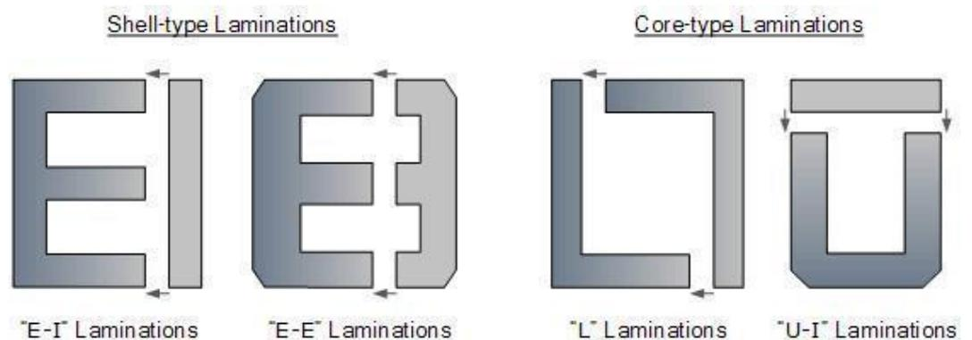
**Gambar 2. 6 Cara Menghubungkan Lapisan Inti Besi Pada Trafo**
