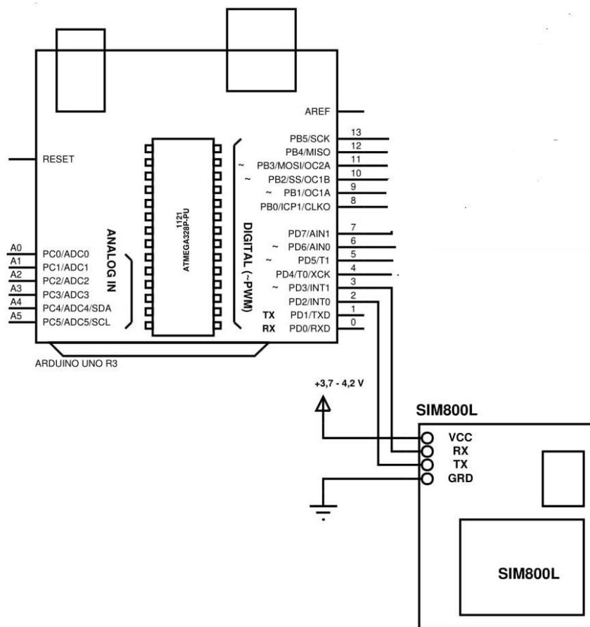
**Gambar 3. 6 Rangkaian SIM800L pada Arduino Uno**
