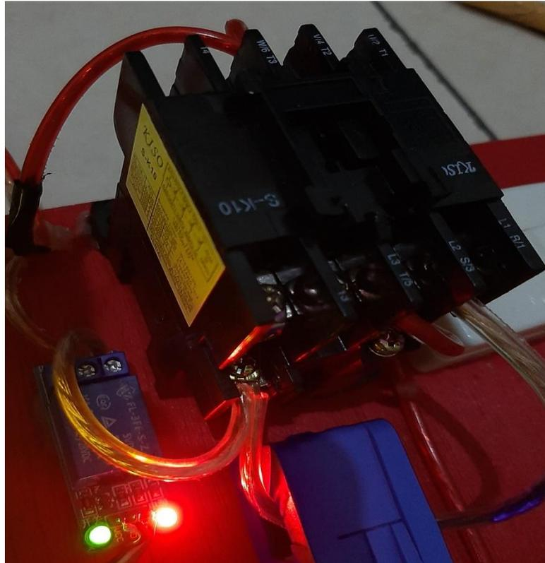
**Gambar 4.7 Pengujian Relay & Kontaktor dalam kondisi ON**
