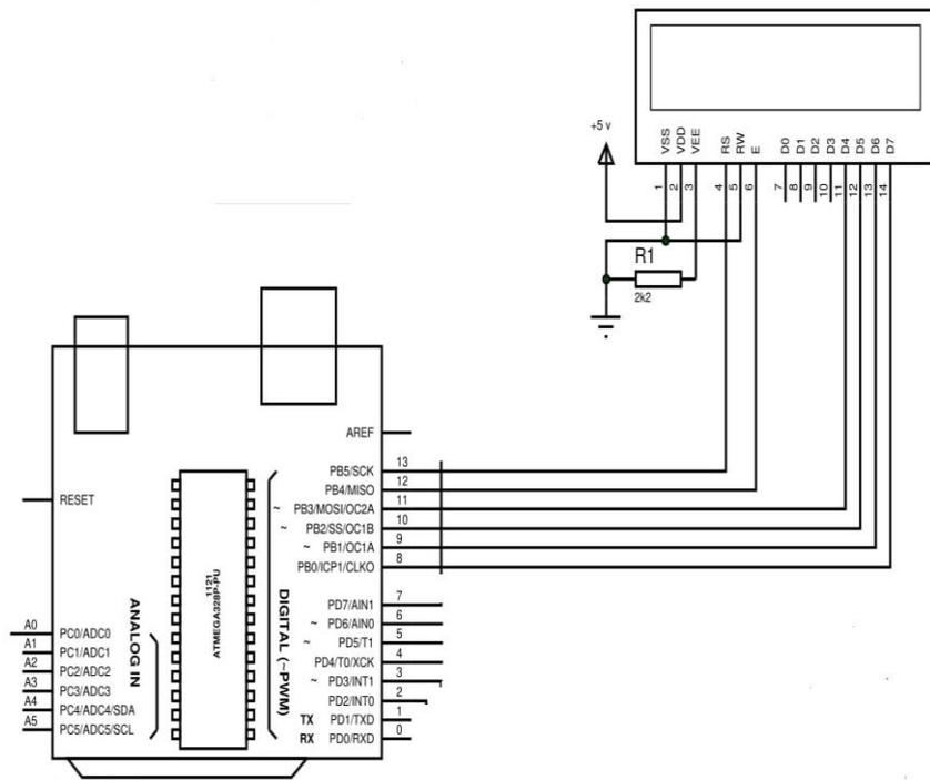
**Gambar 3. 8 Rangkaian LCD pada Arduino Uno**
