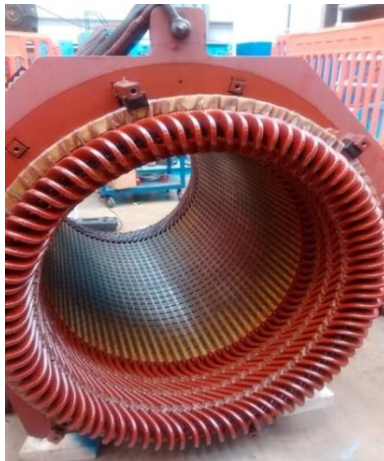
Gambar 2.3 Inti Stator dan Alur Pada Stator
