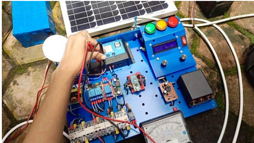
Gambar 4. 2 Pengukuran Sell Surya dengan Multimeter Sumber : Penulis,2021
