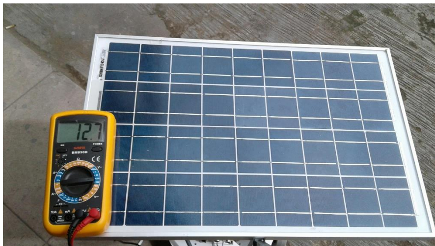
Gambar 4.2 Proses pengukuran tegangan panel
