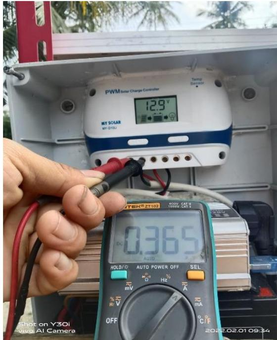
**Gambar 4. 2** Pegukuran Arus menggunakan Multitester
