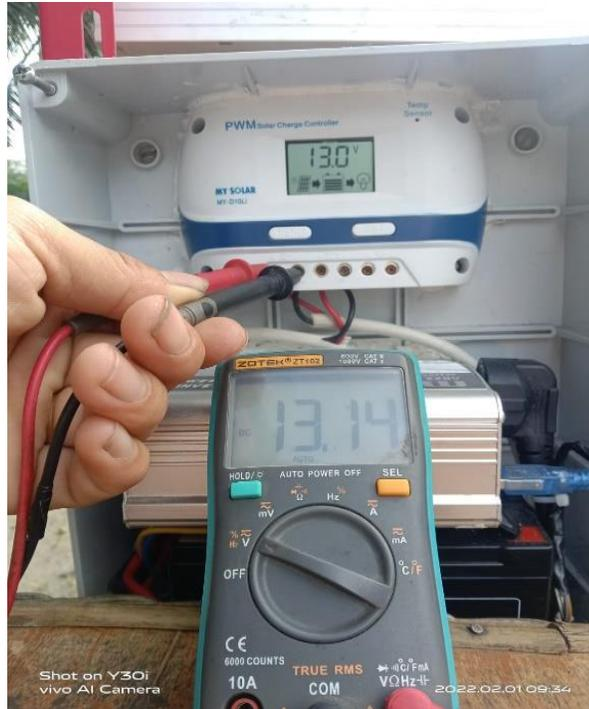
**Gambar 4. 1 Pengukuran Tegangan Menggunakan Multimeter**
