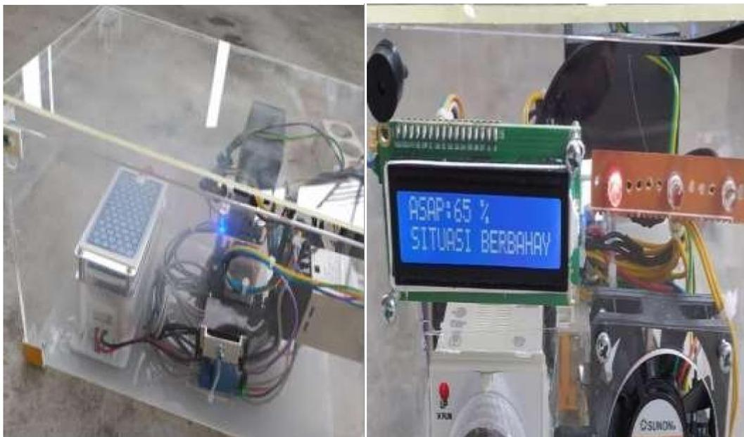
**Gambar 4.3** Pengujian Ke III Sensor MQ-2 Terhadap Ketebalan Asap
