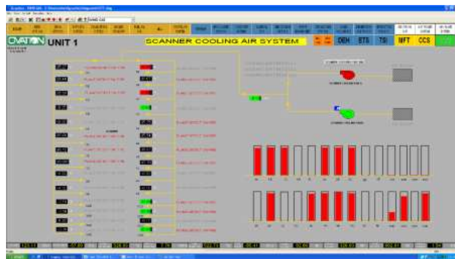
Gambar 3.4 Tampilan Scanner Cooling Air Fan Ketika Normal Operasi Sumber: Penulis, 2020
