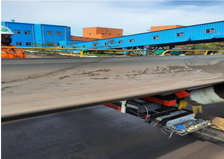
Gambar4.1 : Implementasi Alat Dongrak di PLTU Pangkalan Susu Sumber: Penulis,2021
