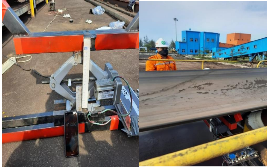
Gambar 3.8 : Kondisi Dongkrak Naik Tanpa beban Sumber: Penulis,2021
