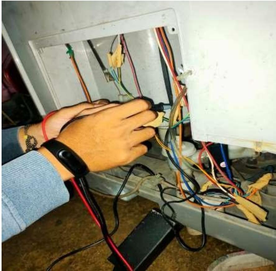
**Gambar 4.3 Pengujian Catu Daya**
