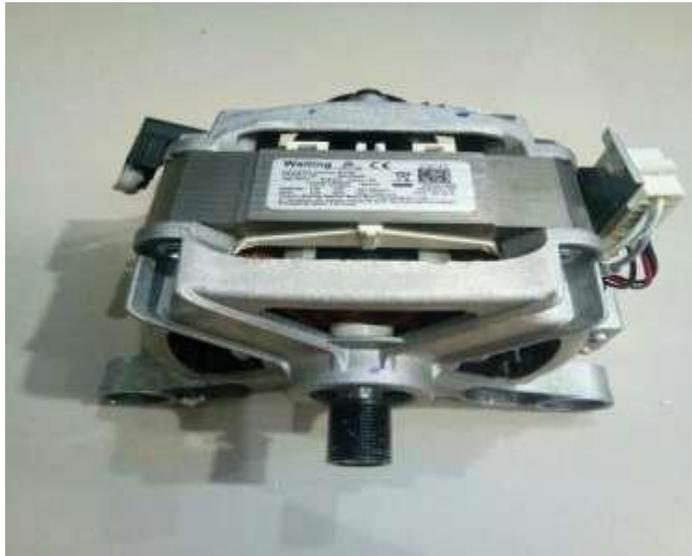
**Gambar 2.1 Motor Penggerak Mesin Cuci**
