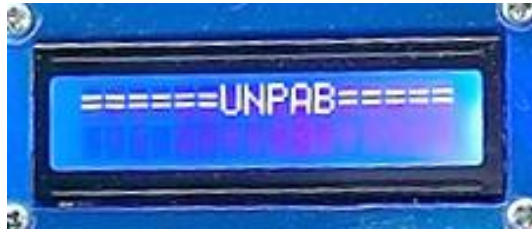
Gambar 4.17 Tampilan LCD 16×2 Berdasarkan Kode Program
