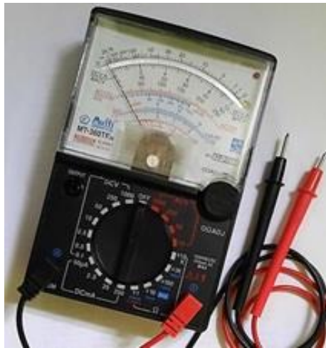
Gambar 4.1 Multimeter Analog untuk Pengukuran Sistem ATS
