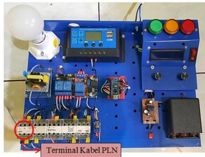
Gambar 4.2 Terminal Kabel PLN
