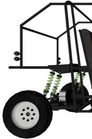
Gambar 4. 4. Posisi Shock Suspensi Pada Lengan lengan bodi
