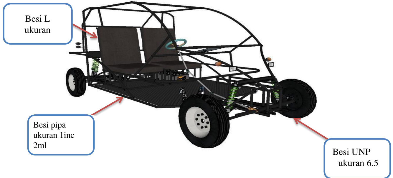
Gambar 3. 5. Desain Rangka Keseluruhan Mobil Listrik Mini
