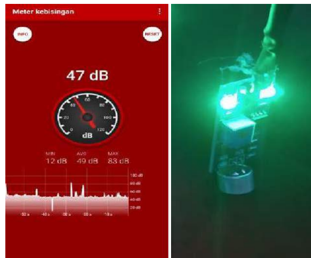
Gambar 4.5 Pengujian Tingkat Kebisingan Sensor 1
