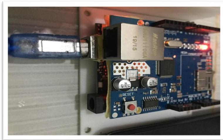
**Gambar 4.7 Rangkaian Arduino Uno dan *Lan Shield***
